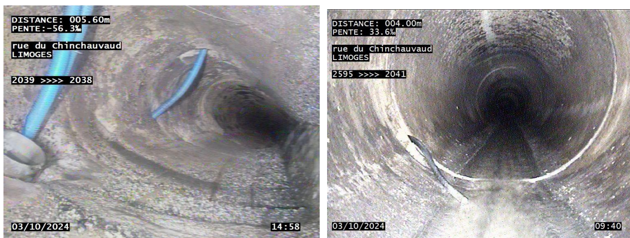
Figure 30 : Exemple d'obstacle issu de conduite externe (à gauche) et de défaut de joint d'étanchéité (à gauche)
